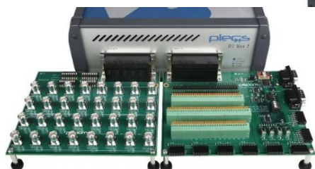
RT Boxに別売のアナログブレイクアウトボードとデジタルブレイクアウトボードを接続した場合
