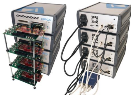
4台のRT-Boxを使用した系統連系モジュラーマルチレベルコンバータ(MMC)のリアルタイムシミュレーション環境
