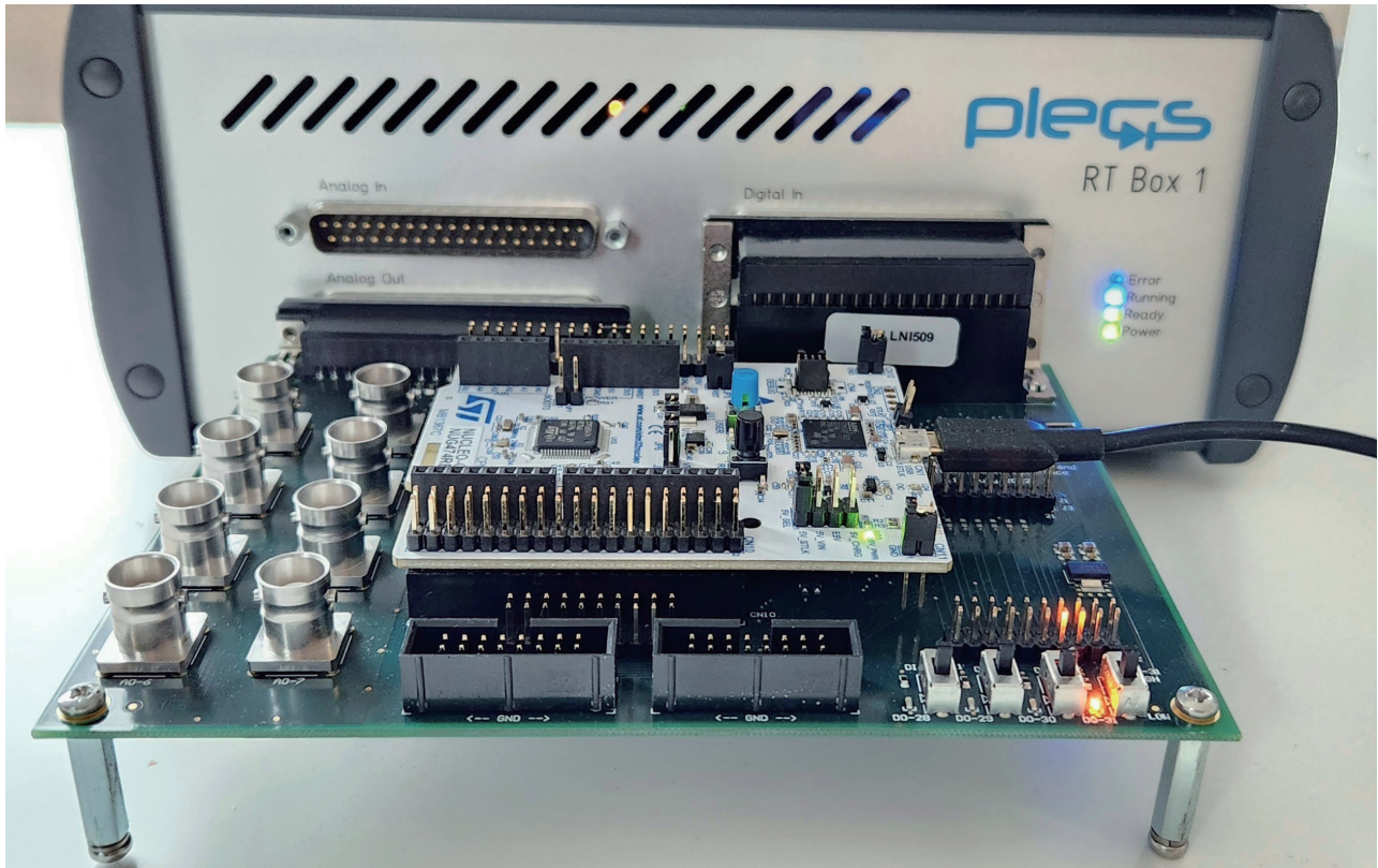
図6: RT BoxとSTM32 Nucleoボードをインタフェースボード経由で接続
