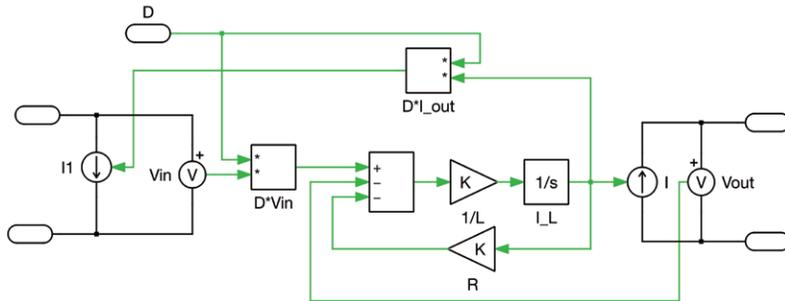
コンバータの平均化モデルにより、充電回路の高速シミュレーションが可能になります。ただし、スイッチング効果がキャプチャされなくなるため、制限が厳しくなります。さらに、シミュレーション速度を維持するために継続的な制御を採用する必要があります。デジタル制御方式を追加すると、制御ループの実行頻度に基づくサンプリング時間が導入されます。コンバータの平均化モデリングは、高レベルのアルゴリズム(SOC推定など)を開発する場合に役立ちます。
