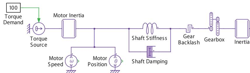
電気自動車を前進させるために使用するモータは、慣性ブロックを使用して、理想的なトルク源と回転質量として簡単な方法でモデリングできます。モータのダイナミクスは次のように表されます：
