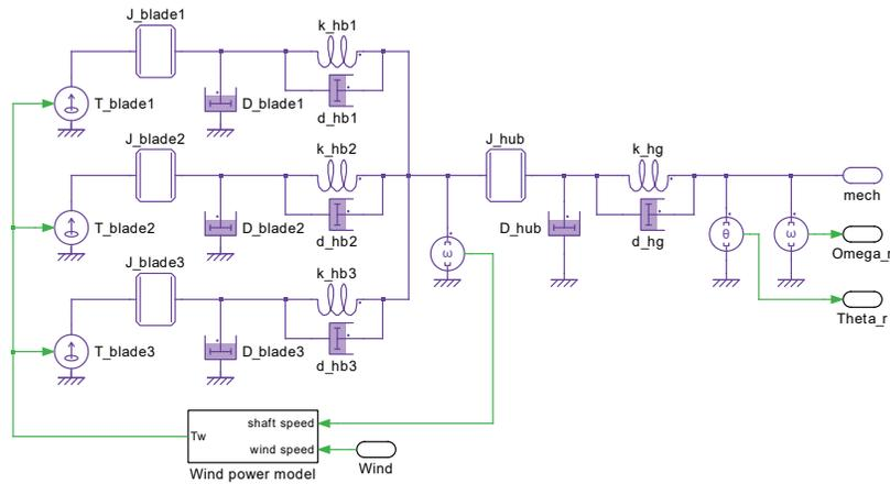
タービンブレードに適用する風トルクの値はルックアップテーブルから取得し、値は風力とシャフトの回転速度によって変化します。
