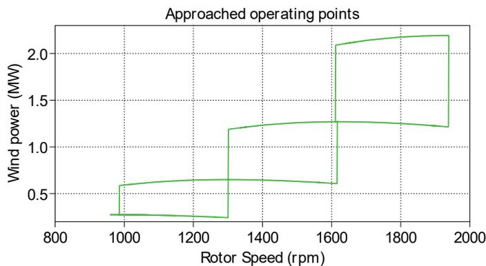
図10: 段階的な風速プロファイルでの時間の経過に伴うMPPTアルゴリズムの動作点へのアプローチ
