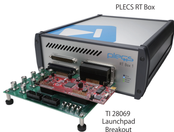
図6: RT Boxを使用したHIL検証のハードウェア設定
