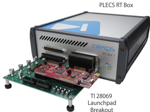
図6: HIL検証のハードウェアセットアップ
