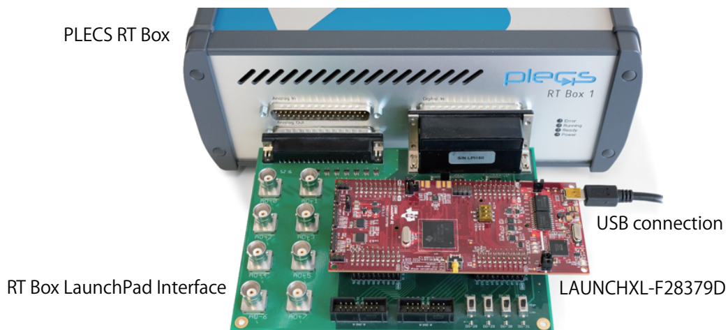
図9: HIL検証のハードウェアセットアップ
