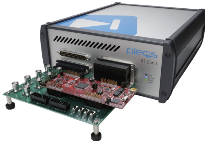
図1: RT Boxを使用したこのチュートリアルのハードウェア設定(オプション)
