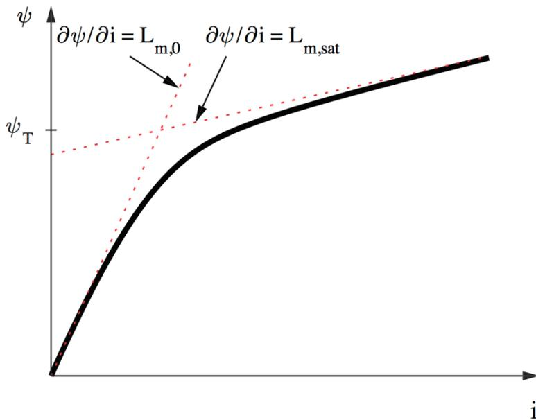
逆正接ベースの解析モデルにより、ユーザは非常に簡単かつ効率的な方法で飽和効果をシミュレーションに組み込むことができます。ただし、このモデルでは、 $i_{dq}$ の増加により発生する $\psi_{dq}$ の飽和のみを考慮します。相互飽和効果を考慮できないことは、解析モデルの大きな欠点です。図3は、相互飽和効果が高いマシンに対する解析モデルの限界を示しています。マシンデータは、InfolyticaのMotorSolveツールを使用して生成されました。
